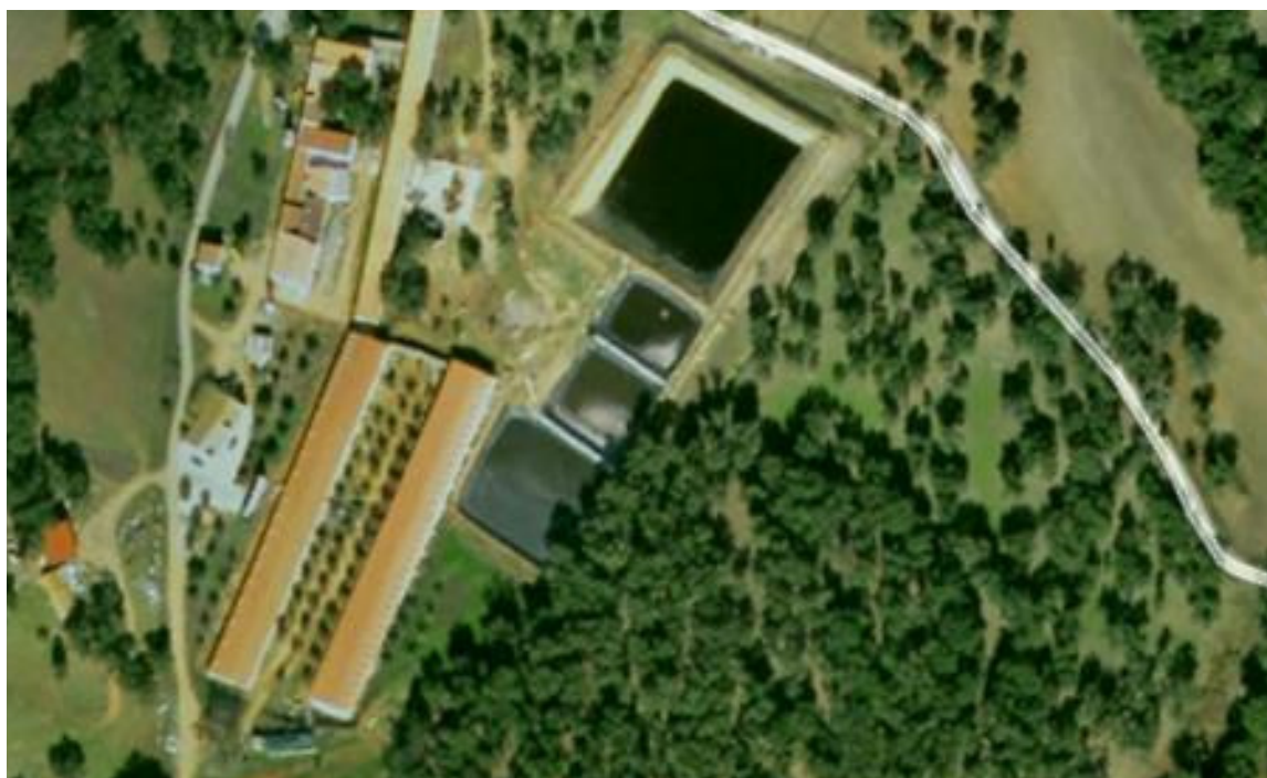
Figura 1 - Implantação do sistema de retenção.
